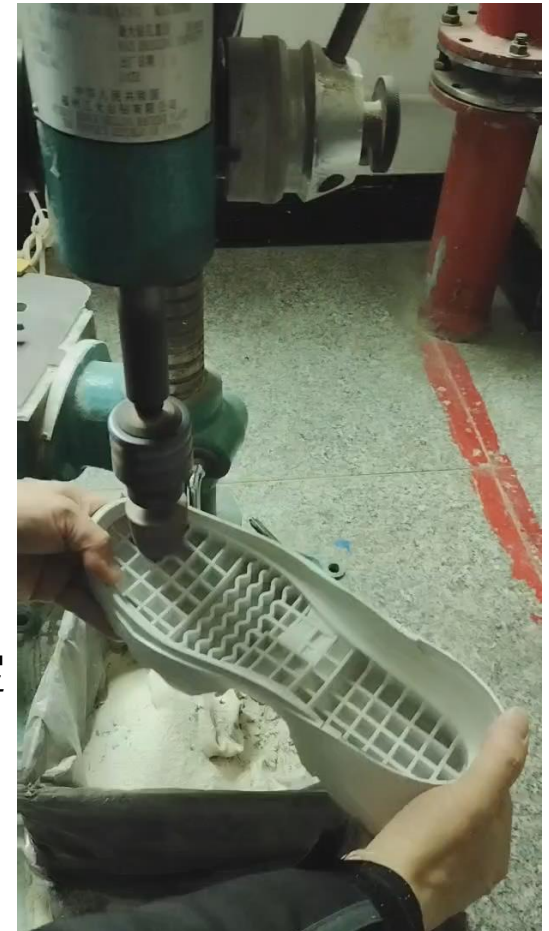
傳統機械打粗設備
